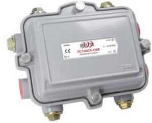
Ein Richtkoppler ist ein ungleicher Leistungsteiler und teilt die Stamm- und Speiseleitungen des Netzwerks auf. Die 1,2-GHz-Nennfrequenz gepaart mit hervorragender Einfügungsdämpfung und Brumm-Modulationsabstandseigenschaften gewährleisten ihre zuverlässige Leistung in den anspruchsvollsten Anwendungen sowie DOCSIS 3.1-Kompatibilität.
